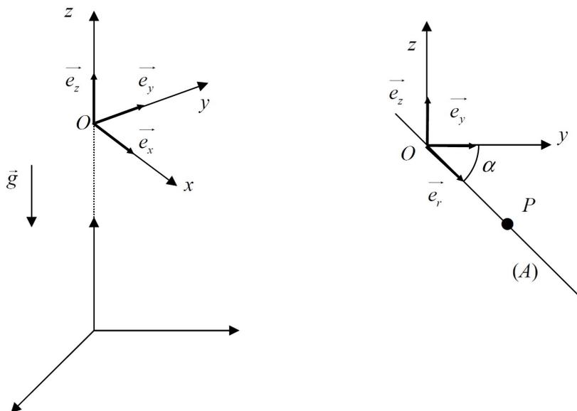
Soit  $(A)$  une droite, fixe relativement à  $\mathcal{R}'$ , située dans le plan  $yOz$ . Cette droite est orientée par le vecteur unitaire  $\vec{u}_r$ , l'angle situé entre les directions de  $\vec{u}_r$  et  $\vec{u}_y$  est noté  $\alpha$ .
