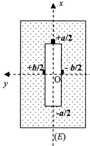
9. Montrer que l'amplitude de l'onde lumineuse diffractée par la fente, représentée sur la *Figure 3* , dans la direction du vecteur unitaire  $\vec{u}_{OM}(\alpha, \beta, \gamma)$  est de la forme  $\Psi_{(u,v)} = \zeta_0 \frac{\sin U}{U} \frac{\sin V}{V}$  . Les paramètres  $\zeta_0$  ,  $U$  et  $V$  seront exprimés en fonction de  $a, b$  dimensions de la fente, de  $\Psi_0(P)$  , de  $\underline{K}$  et des fréquences spatiales  $u$  et  $v$  pour la longueur d'onde  $\lambda$  .
