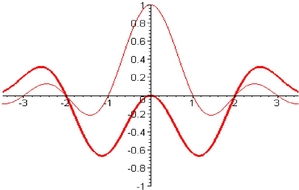
Tracés de  $\text{sinC}^2(U)$  et de  $[\text{sinC}(U) - \text{sinC}(U/2)]^2$  (en abscisse, on a  $U/\pi$ )
