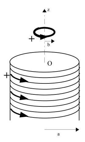
Avec d'autres conditions expérimentales (un opérateur guidant l'anneau), on peut observer un équilibre de lévitation magnétique.
